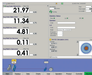
Hauptbildschirm mit u.a. Leitungsschema, Status- und Geräteansicht sowie Kennlinienansicht.
