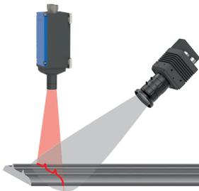
Das Messprinzip basiert auf 2D-Laser-Triangulation bzw. Lichtschnitttechnik. Vier oder mehr Laser beleuchten die Produktoberfläche und die zugehörigen Matrixkameras erfassen die Lichtkontur aus einem schrägen Winkel. Ein leistungsstarker und schneller Rechner und die PROFILEMASTER Software setzen die erfassten Segmente zu einem orthogonalen Profilquerschnitt zusammen.
