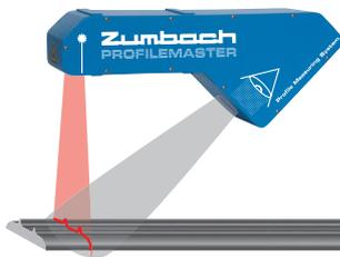
Das Messprinzip basiert auf 2D-Laser-Triangulation bzw. Lichtschnitttechnik. Vier oder mehr Laser beleuchten die Produktoberfläche und die zugehörigen Matrixkameras erfassen die Lichtkontur aus einem schrägen Winkel. Ein leistungsstarker und schneller Rechner und die PROFILEMASTER Software setzen die erfassten Segmente zu einem orthogonalen Profilquerschnitt zusammen.
