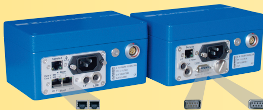
CI 1J/EN-EN (Ethernet TCP/IP) CI 1J/EN-RS (sérielle) CI 1J/EN-DP (Profibus DP) CI 1J/EN-PN (Profinet IO) CI 1J/EN-EI (EtherNet/IP)
