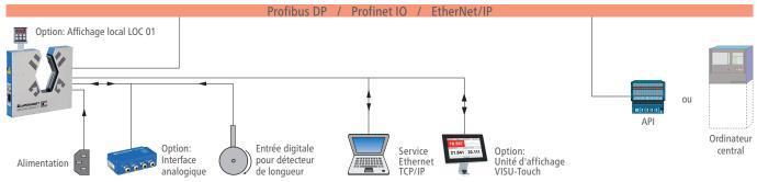
Un processeur intégré permet la surveillance des mesures, l'évaluation des statistiques, le paramétrage et bien d'autres fonctions. Ces versions communiquent via l'interface Profibus DP, Profinet IP ou EtherNet/IP intégrée avec le système supérieur. Ces interfaces sont conçues pour un échange rapide de données au niveau des bus de terrain. À ce niveau les
