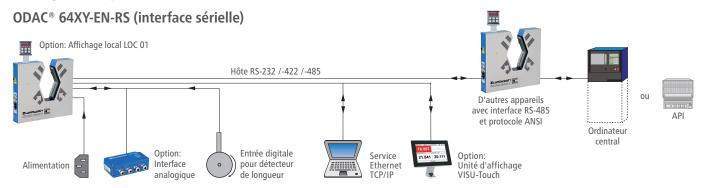
Un processeur intégré permet la surveillance des mesures, l'évaluation des statistiques, le paramétrage et bien d'autres fonctions. La version RS communique via l'interface sérielle RS intégrée avec un système supérieur, comme USYS de Zumbach, ordinateur central (ou API). Les
