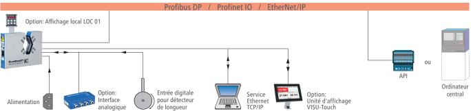
Un processeur intégré permet la surveillance des mesures, l'évaluation des statistiques, le paramétrage et bien d'autres fonctions. Ces versions communiquent via l'interface Profibus DP, Profinet IP ou EtherNet/IP intégrée avec le système supérieur. Ces interfaces sont conçues pour un échange rapide de données au niveau des bus de terrain. À ce niveau les
