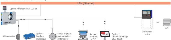
Un processeur intégré permet la surveillance des mesures, l'évaluation des statistiques, le paramétrage et bien d'autres fonctions. La version EN communique, via l'interface Ethernet intégrée, avec le système supérieur. Les valeurs de mesure et paramètres sont intégrés à l'aide
