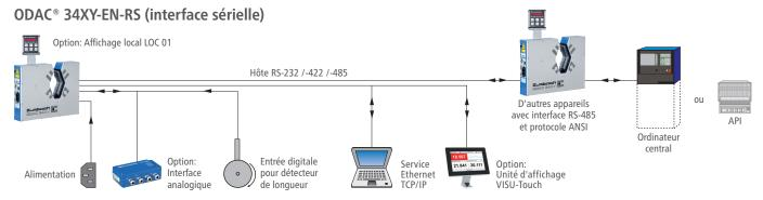
Un processeur intégré permet la surveillance des mesures, l'évaluation des statistiques, le paramétrage et bien d'autres fonctions. La version RS communique via l'interface sérielle RS intégrée avec un système supérieur, comme USYS de Zumbach, ordinateur central (ou API). Les
