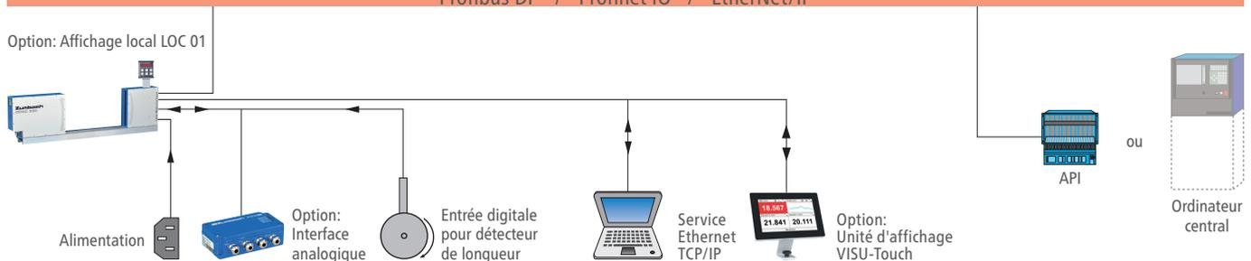
Un processeur intégré permet la surveillance des mesures, l'évaluation des statistiques, le paramétrage et bien d'autres fonctions. Ces versions communiquent via l'interface Profibus DP, Profinet IP ou EtherNet/IP intégrée avec le système supérieur. Ces interfaces sont conçues pour un échange rapide de données au niveau des bus de terrain. À ce
