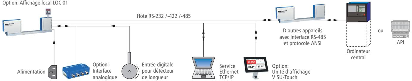
Un processeur intégré permet la surveillance des mesures, l'évaluation des statistiques, le paramétrage et bien d'autres fonctions. La version RS communique via l'interface sérielle RS intégrée avec un système supérieur, comme USYS de Zumbach, ordinateur central (ou API). Les
