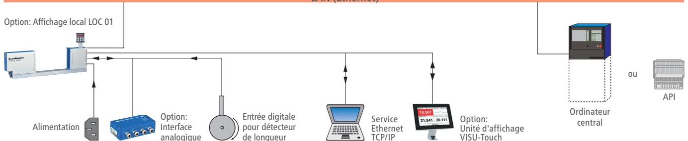
Un processeur intégré permet la surveillance des mesures, l'évaluation des statistiques, le paramétrage et bien d'autres fonctions. La version EN communique, via l'interface Ethernet intégrée, avec le système supérieur. Les valeurs de mesure et paramètres sont intégrés à l'aide
