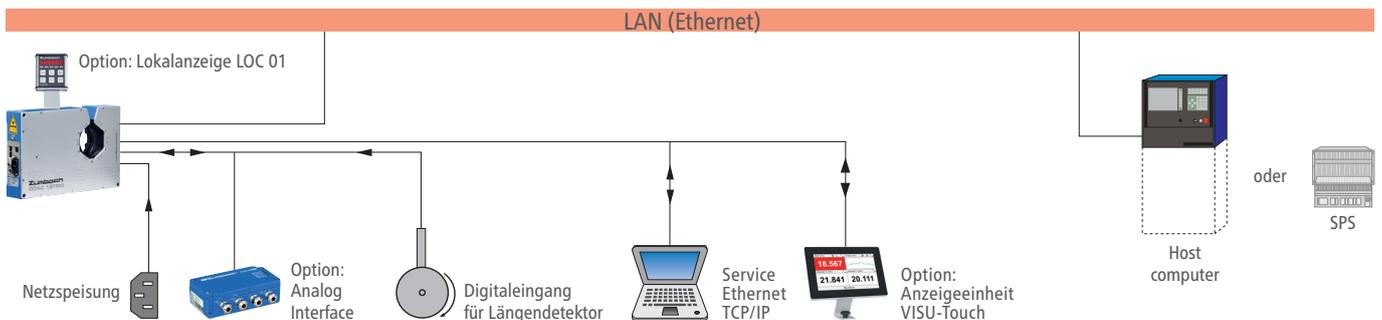
Ein eingebauter Prozessor ermöglicht Erfassung und Überwachung der Messwerte, sowie Statistikfunktionen, Parameterauswahl und viele weitere Funktionen. Die EN-Variante kommuniziert über die integrierte Ethernet-Schnittstelle mit einem übergeordneten System. Die Messwerte
