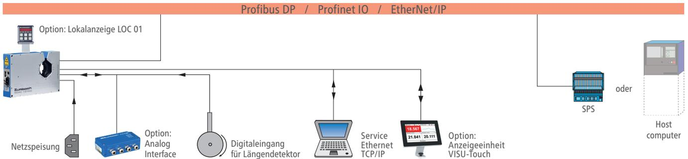
Ein eingebauter Prozessor ermöglicht Erfassung und Überwachung der Messwerte, sowie Statistikfunktionen, Parameterauswahl und viele weitere Funktionen. Diese Varianten kommunizieren über die integrierte Profibus DP-, Profinet IO oder EtherNet/IP-Schnittstelle mit einem übergeordneten System. Diese Schnittstellen sind für den
