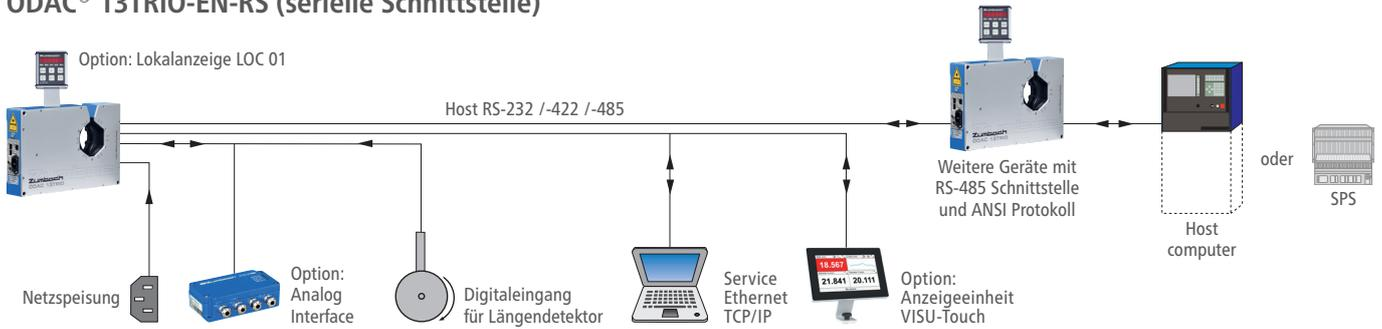
Ein eingebauter Prozessor ermöglicht Erfassung und Überwachung der Messwerte, sowie Statistikfunktionen, Parameterauswahl und viele weitere Funktionen. Die RS-Variante kommuniziert über die integrierte RS-Schnittstelle mit einem übergeordneten System wie USYS von
