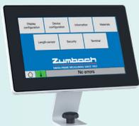
Robuster und kompakter 10-Punkt-P-CAP-Touchscreen. Einfache Installation der Bedienanzeige an einem entfernten Ort – komfortabel für den Bediener. Es ermöglicht dem Bediener, das Vorheizgerät einzurichten und ein- und auszuschalten, ohne in der Nähe zu sein (erfordert ein optionales Verbindungskabel).
