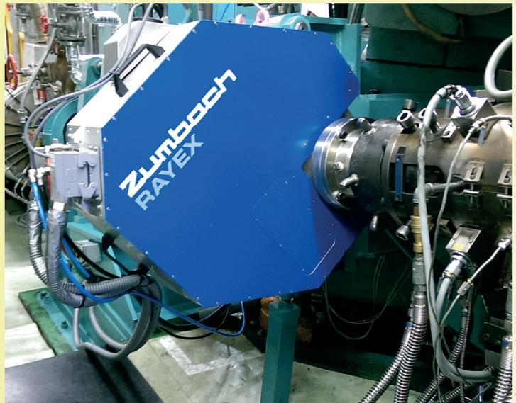
**RAYEX® ist ein modernes & hochpräzises, auf Röntgenstrahlen basierendes, Mess- & Regelsystem für Wanddicke (3 Schichten), Exzentrizität, Durchmesser / Ovalität**
